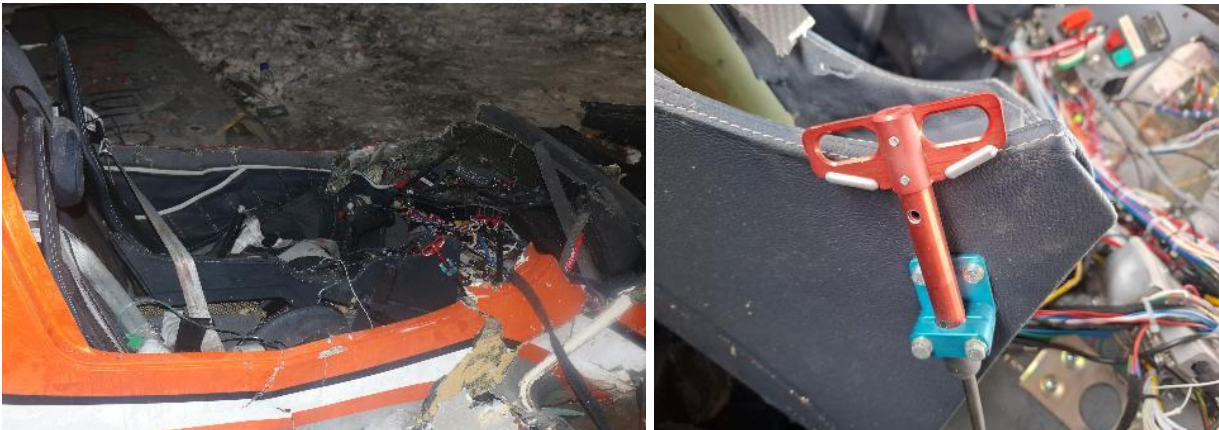
Obr. č. 13 – Odjištěný ovladač aktivace záchranného systému
